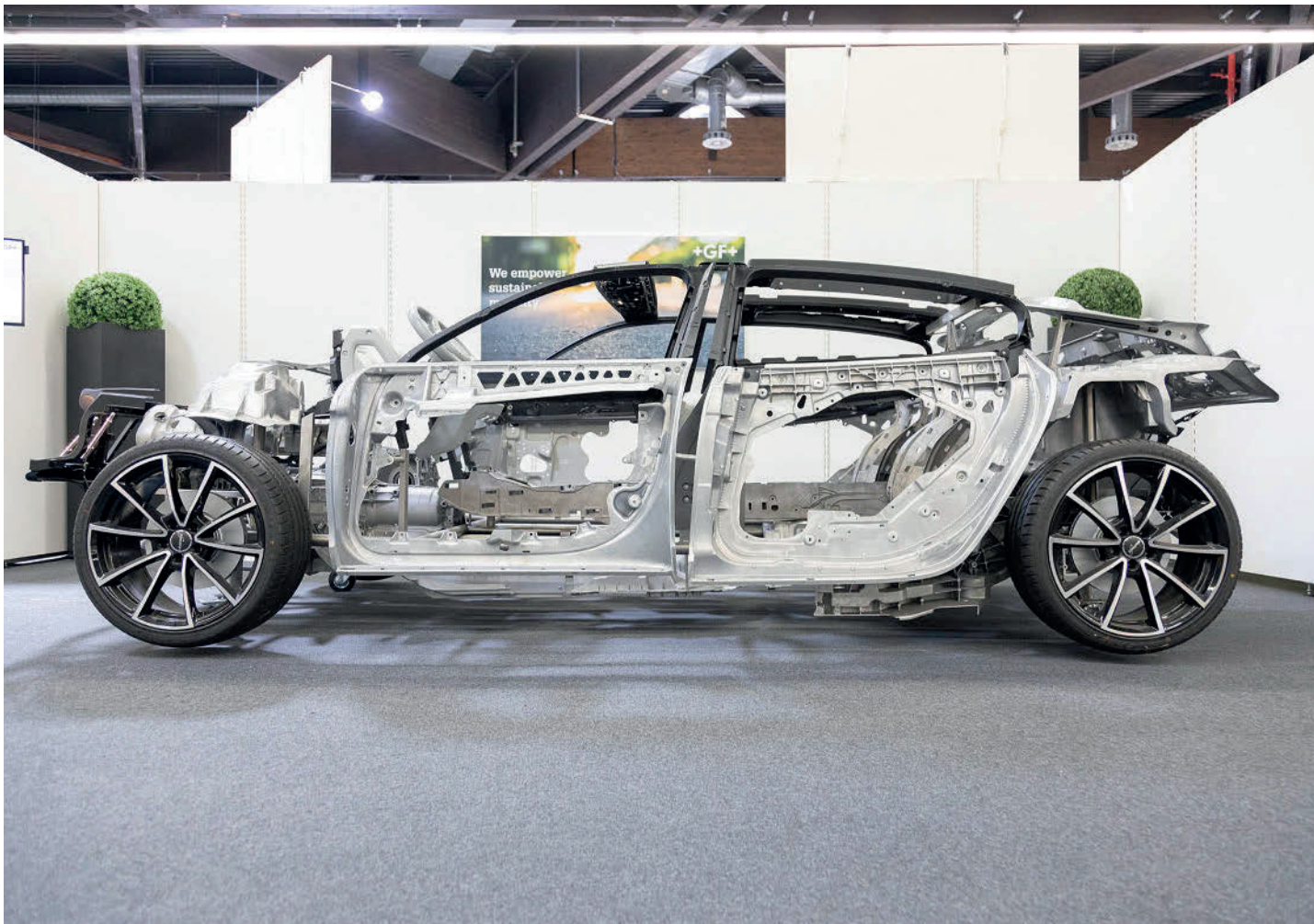
GF Casting Solutions zeigte seine Kompetenz in Sachen Leichtmetallbau für Automobilhersteller. Das hier ausstellte Showcar für Renault ist ein Hybrid-Konzept mit einem von GF gefertigten Batteriegehäuse.
