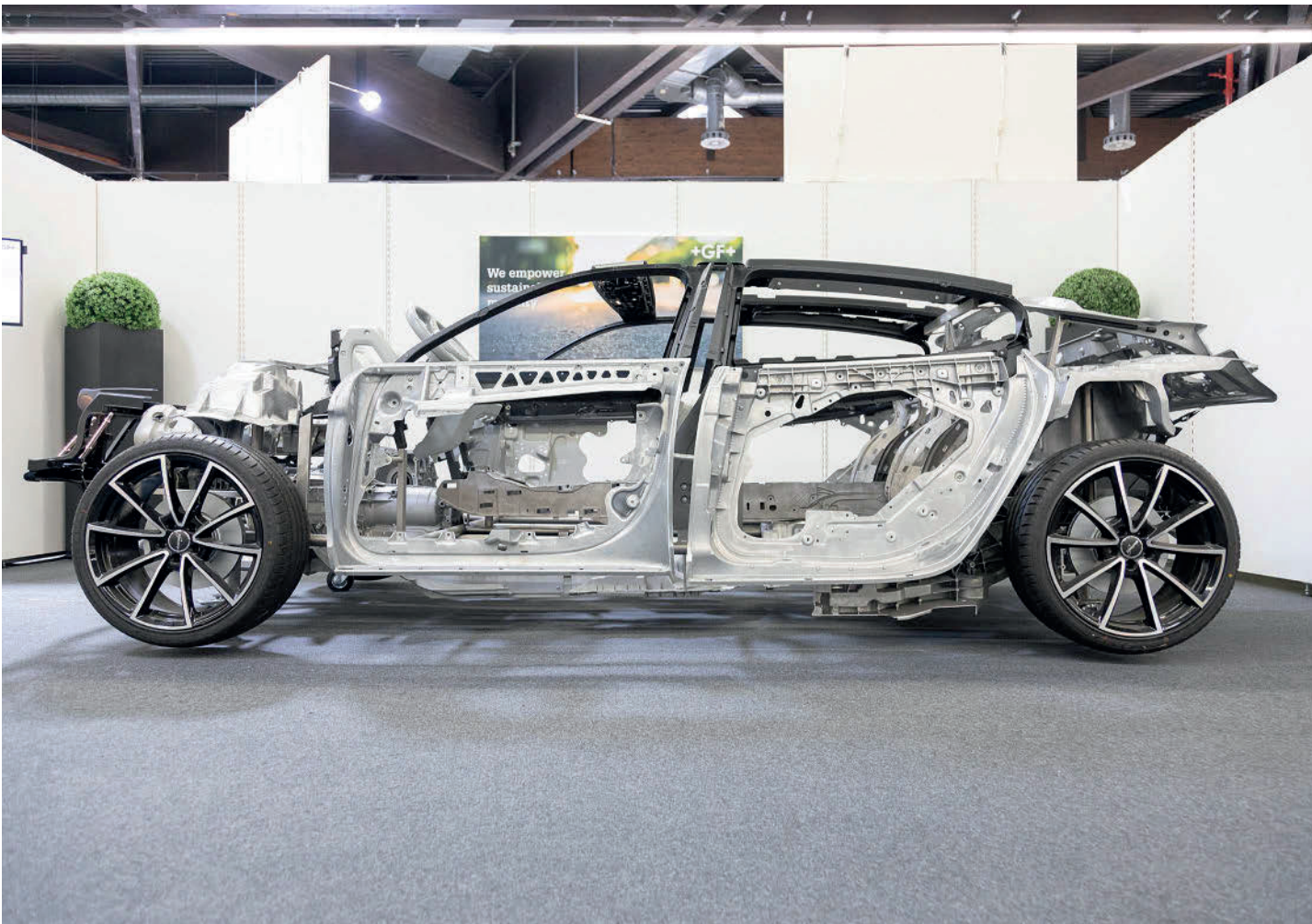
GF Casting Solutions zeigte seine Kompetenz in Sachen Leichtmetallbau für Automobilhersteller. Das hier ausgestellte Showcar für Renault ist ein Hybrid-Konzept mit einem von GF gefertigten Batteriegehäuse.
